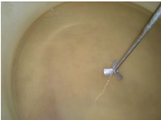
Fotografías 13 y 14. Sistema de suspensión y mezclado con agitación mediante hélice de la solución madre.
