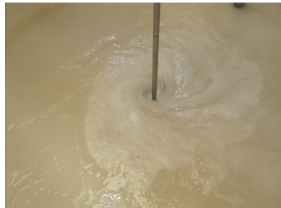
Fotografías 13 y 14. Sistema de suspensión y mezclado con agitación mediante hélice de la solución madre.
