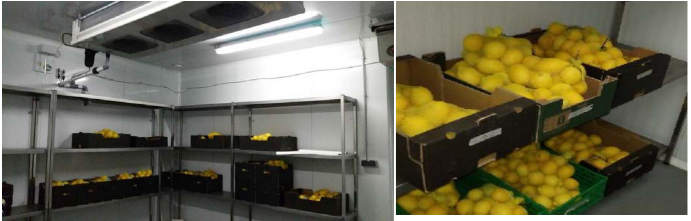
Fotografías 34 y 35. Conservación frigorífica del limón Fino 49 bajo diferentes tratamientos pre y postcosecha en una cámara de la Planta Piloto del IBV- UPCT.
