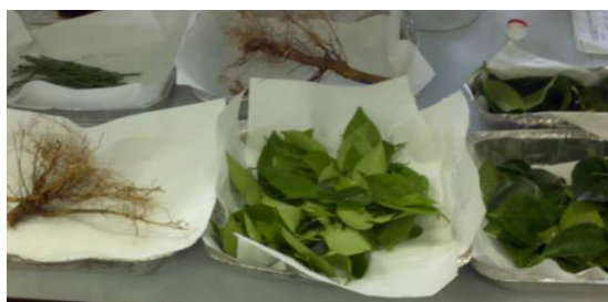
Fotografía 1.- Preparación de muestras para el análisis: lavado, clasificación por órganos y secado.
