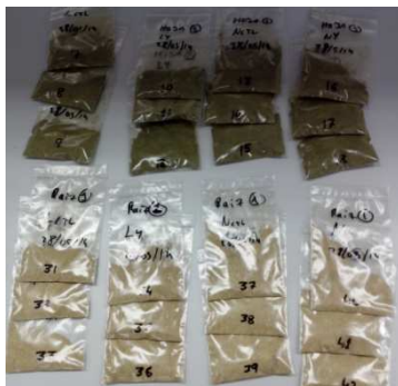
Fotografía 2.- Muestras secadas, molidas, tamizadas, embolsadas y etiquetadas.
